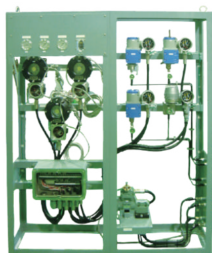
計器スタンド (パッケージ内:耐圧防爆計器)
