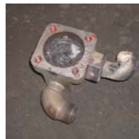
逆止弁の炭化物清掃、除去を行わず炭化物が堆積した例です。
