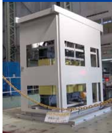
動的耐震強度検証(加振試験)
