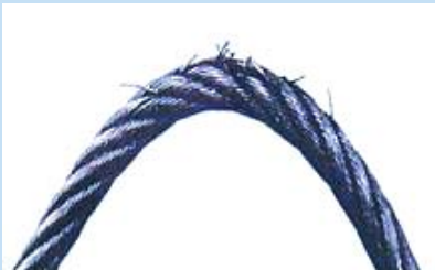
経年劣化により素線切れしたロープホイスト (ロープ部)
