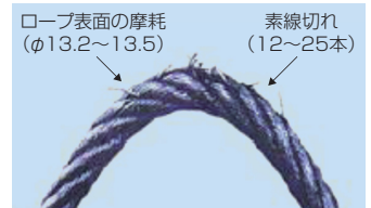
ロープ表面の摩耗 (φ13.2~13.5) 素線切れ (12~25本) 経年劣化により素線切れした ホイストワイヤーロープの例
