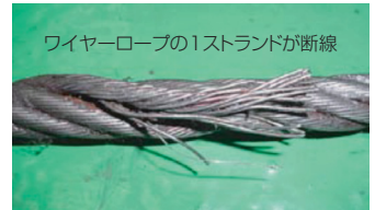
ワイヤーロープの1ストランドが断線 経年劣化により断線した ホイストワイヤーロープの例
