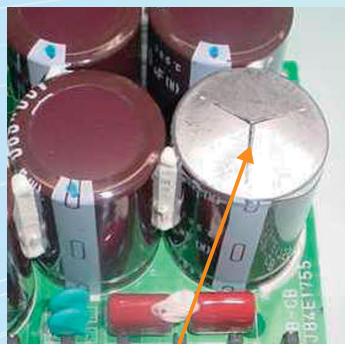
電解コンデンサの防爆弁開放
