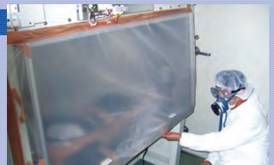
点検前滅菌作業
